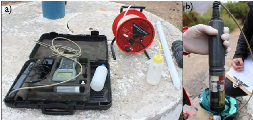
Figura 4. Materiales utilizados en campañas de terreno. En a) se observa multiparámetro, pozómetro y bailer, en b) se muestra proceso de medición de parámetros fisicoquímicos.
