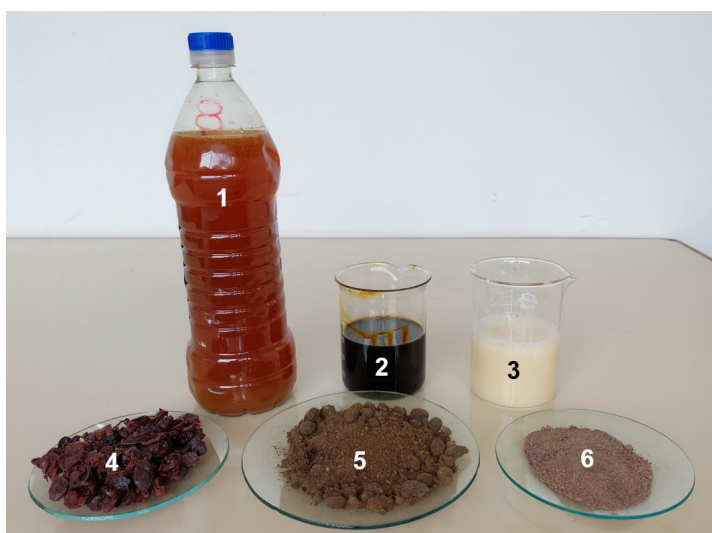
Foto 1. Producto final (1) y algunos insumos utilizados para la elaboración de bioles: melaza (2), leche cruda (3), orujo agotado (4), estiércol de cabra (5) y ceniza de madera (6). Fuente: Laboratorio de Química Agrícola, Facultad de Ciencias Agrarias, Universidad Nacional de Cuyo
