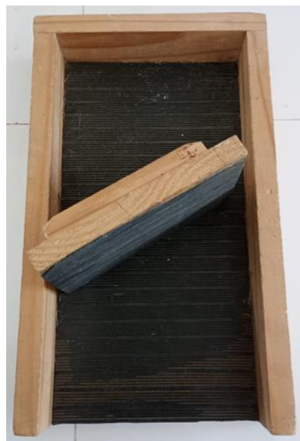
Figura 2. Caja de madera forrada con gomas utilizada para desglumar los cariopsis.
