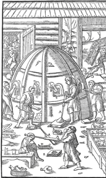
A. PIPAS DE SOPLO B. RESQUICIOS C. EMBOCADURAS DE MÁRMOL D. FORCEPS E. MOLDURAS
