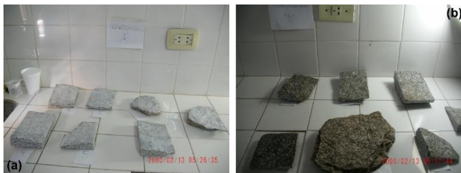
Figura 5. Rocas soporte utilizadas en la experimentación: (a) Conjunto A de las muestras de roca, con aplicación de enlucido a la cal; (b) Conjunto B de las muestras de roca para experimentación, sin enlucido. Fuente: fotografías de los autores.
