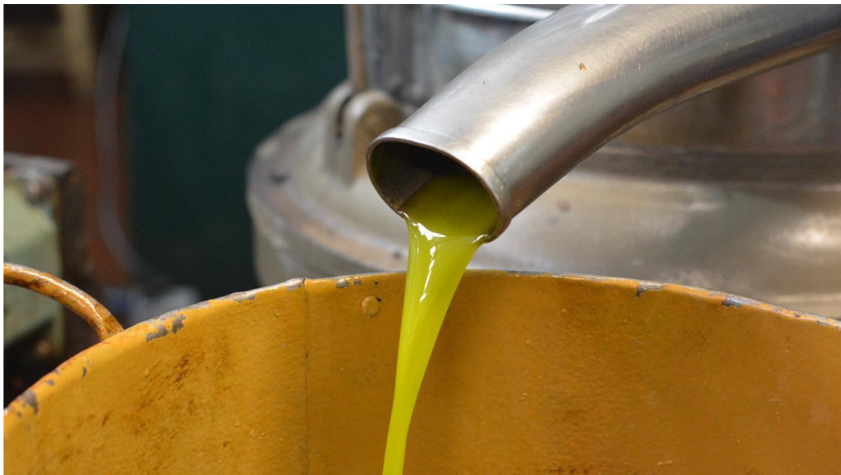
Figura 1. Salida de la centrífuga vertical donde se separa la última fracción de agua de vegetación del aceite.
