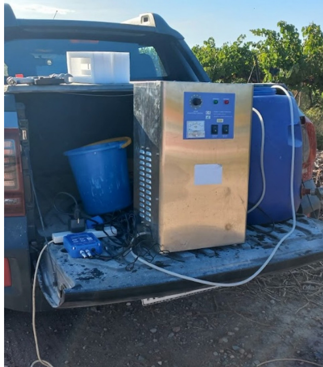
Figura 2. Equipo de generación de ozono gaseoso para el enriquecimiento de agua.
