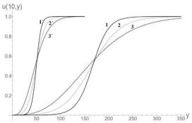
**Figura 2.** Proyección curvas solución *a+b* cte y *d*=0. 1´) *a*=0, *b*=0.2 Bohart Adam; 2´) *a*=0.05, *b*=0.15;3´) *a*=0.2, *b*=0 Alzenius. 1) *a*=0 y *b*=0.06 Bohart Adam 2´) *a*=0.03 y *b*=0.03; 3´) *a*=0.06 y *b*=0 Alzenius
