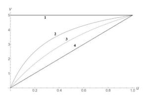
**Figura 4.** Isotermas de adsorción batch teóricas en las variables *u*, *v*. Los colores y numeración se corresponden a la figura 1: 1) *a*=0, *b*=0.2 Isoterma rectangular asociada a Bohart Adams; 2) *a*=0.05, *b*=0.15 isotermas tipo Lagmuir; 3) *a*=0.1, *b*=0.1 Isotermas tipo Lagmuir; 4) *a*=0.2, *b*=0. Isoterma lineal asociada a Alzenius
