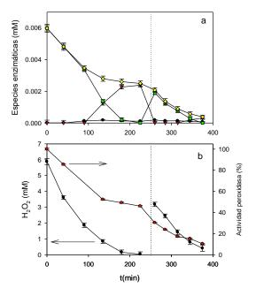
Figura 5. a) Concentración de las especies E<sub>0</sub> (negro), E<sub>2</sub> (rojo), E<sub>3</sub> (verde), y suma de las especies activas (amarillo) en función del tiempo. b) Concentración de peróxido (negro) y actividad peroxidasa (rojo). La línea punteada indica un segundo pulso de peróxido.
