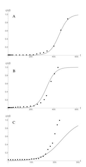
**Figura 5.** Proyección de curvas de ruptura teóricas (líneas llena) con observaciones de curvas de ruptura experimentales (línea punteada). Condiciones:
