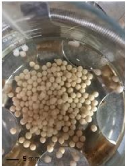
Figura 3. Esferas de alginato de calcio con alimento balanceado encapsulado. Condiciones de trabajo: alginato 0,6% P/V con 25% P/V de alimento.
